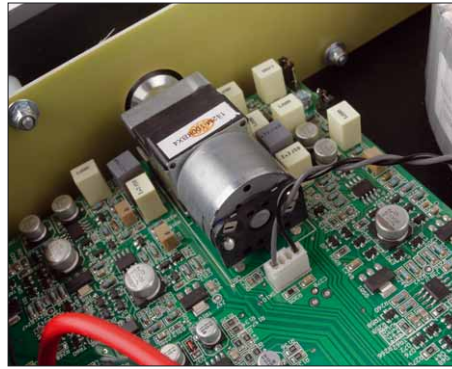
Für Pegelfragen zuständig: das Alps-Motorpoti
