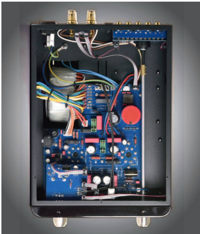
EINFACHER AUFBAU: Die Schaltung des Simply Italy belässt es beim Notwendigen. Ein Ringkerntrafo stellt die Stromversorgung sicher, oben ist noch Platz für die DAC-Platine.
