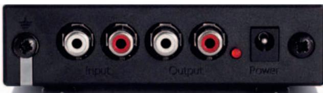
**NUR DAS NÖTIGE:** Die Rückseite ist voll mit Ein/Ausgängen, der Buchse für das Stecker-netzteil plus Diode.
