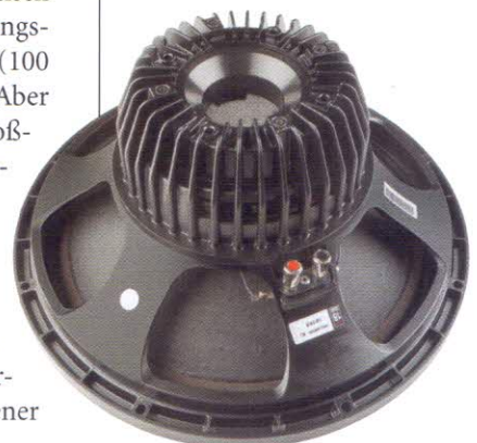
Der Tieftöner mit Neodymantrieb und Alu-Kühlkörper ist mit 800 Watt belastbar
