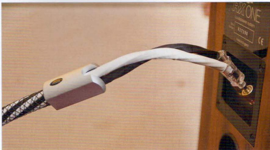
*Etwas ungünstig gelöst sind die aufwärts gerichteten Anschlüsse der RX-Serie, denn dadurch liegt permanent Last auf den Buchsen*
