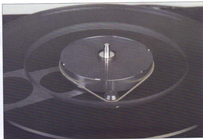
Unter der Filzmatte zeigt sich der Glasteller des Rega Planar 6 von seiner aufgeschlossenen Seite. Der Riemen am Innenboarder und der Subteller sind gut zu erkennen
