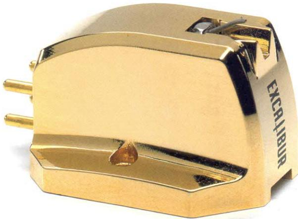
Fähigkeiten zugutekommt. Allen Abtastern dieser Serie ist die mittlere Nadelnachgiebigkeit an der Grenze zur niedrigen und damit die Eignung für die Montage in mittelschweren bis schweren Tonarmen gemein. Der empfohlene Abschlusswiderstand liegt bei 300 Ohm. Das Excalibur Gold high gloss verfügt über einen Echtdiamanten mit Shibata-Schliff, der auf einem Nadelträger aus Aluminium befestigt ist.
