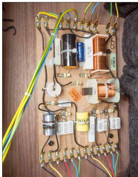
Die Frequenzweiche der Arden. Sehr ordentlich mit Lötleisten handverdrahtet, fast wie ein Vintage-Röhrenverstärker
