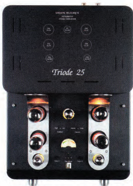
Aus der Vogelperspektive erkennt man schön die Röhrenaufteilung und die einfach zu bedienende Ruhestromeinstellung
