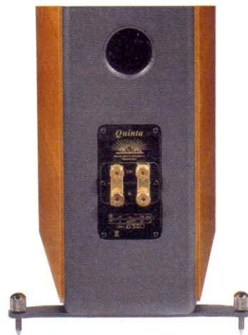
seite müssen die entsprechenden Zweige der Weiche separat zugänglich sein – statt einem findet man dort zwei Plus-Minus-Klemmenpärchen, im Lieferzustand mit Blech- oder Drahtbrücken verbunden. Für Bi-Wiring entfernt man diese Brücken, verlegt ein zweites Kabelpaar und hofft auf Verbesserungen – die allerdings meistens minimal bleiben.
