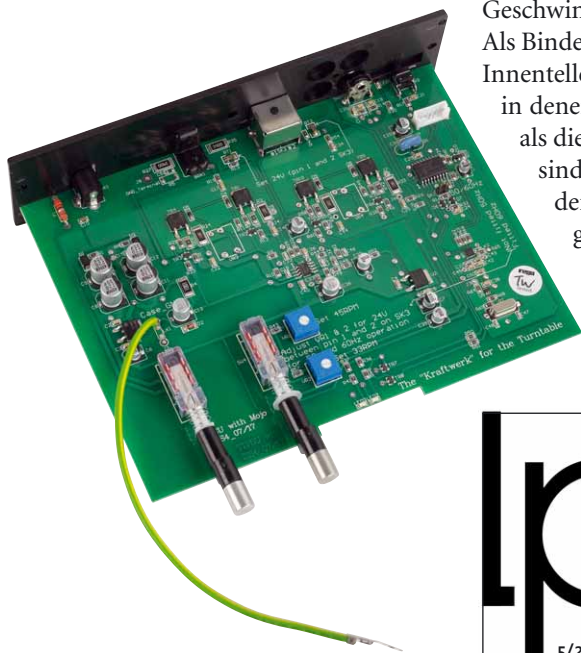
Die Motorsteuerung liefert zwei präzise Sinusspannungen und wird individuell auf jeden Motor justiert
