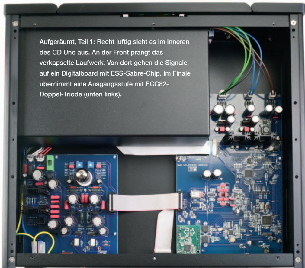
Aufgeräumt, Teil 1: Recht luftig sieht es im Inneren des CD Uno aus. An der Front prangt das verkapselte Laufwerk. Von dort gehen die Signale auf ein Digitalboard mit ESS-Sabre-Chip. Im Finale übernimmt eine Ausgangsstufe mit ECC82-Doppel-Triode (unten links).
