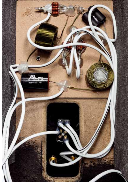
Eher rustikal, aber funktional: die Frequenzweiche der Max Mini
