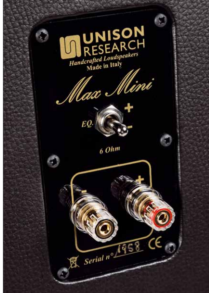
Der Schalter zur Pegelanpassung des Hochtöners in drei Stufen hat nur eine subtile Wirkung
