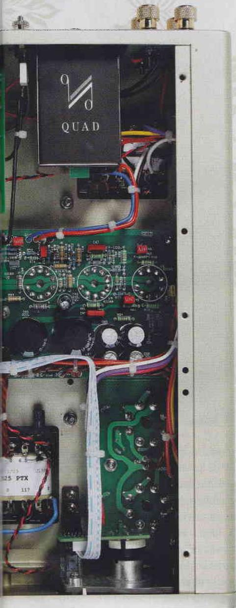
**BESSER DENN JE:** Bauteile (etwa der massive Eingangswähler oben links) und Finish des in China gebauten Integrated hätten auch Quad-Vater Peter Walker überzeugt. In der Logo-verzierten Abschirmdose unten steckt ein (Transistor-) Phonoteil.
