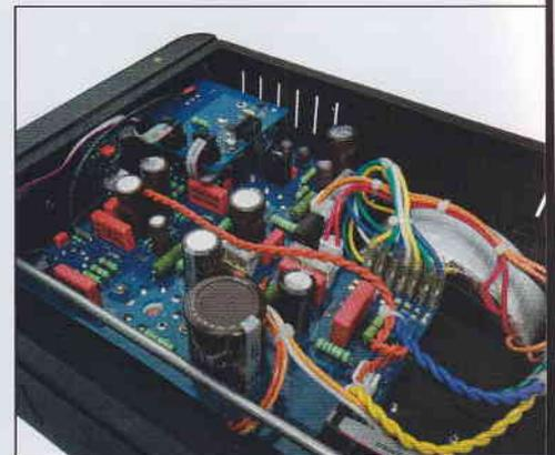
Der Aufbau des Gerätes findet weitgehend auf einer großen Hauptplatine statt, das kleine Board rechts oben ist der Fernbedienungsempfänger
