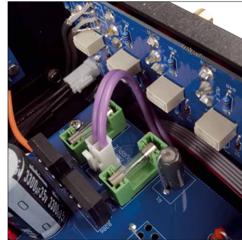
Relais besorgen die Eingangswahl direkt hinter den Buchsen
