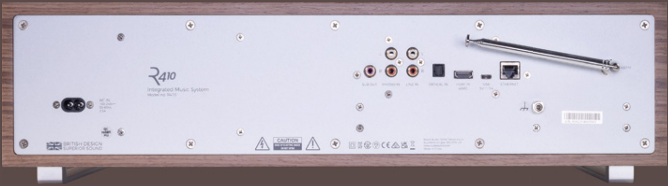
Das R410 bietet nicht nur diverse kabellose Konnektivität, sondern lässt sich zusätzlich mit einem Plattenspieler, Fernseher und CD-Player erweitern
