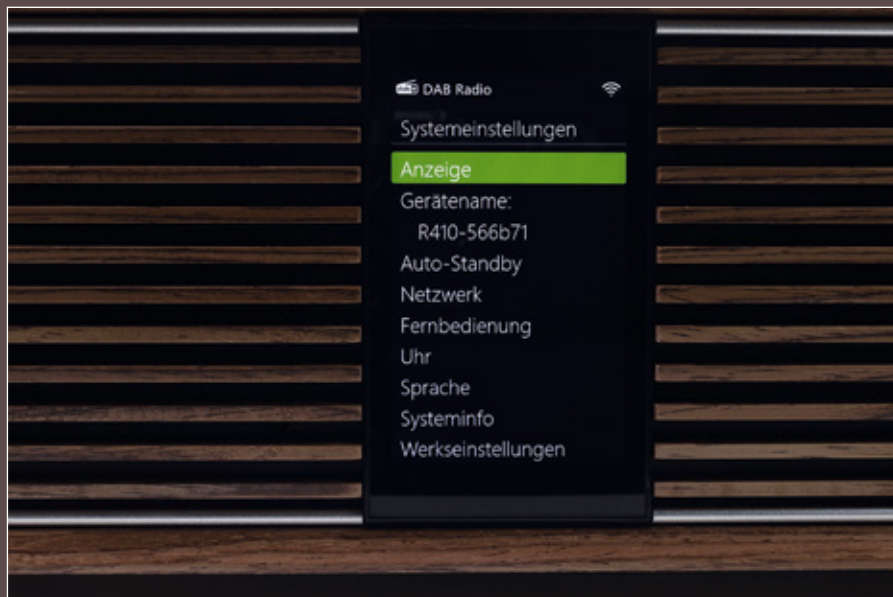
Das Display erinnert durch seine horizontale Anordnung gewollt an ein Smartphone. Es misst vier Zoll und stellt Cover und Schrift mit einer guten Auflösung dar
