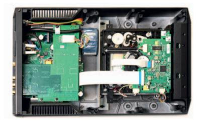
Gewaltenteilung: Rechts sehen wird das Laufwerk in Mechanik und Steuerung. Dann eine Trennwand. Dahinter (links) liegt ein kleiner Trafo, der Wandler und die analoge Ausgangsstufe.
