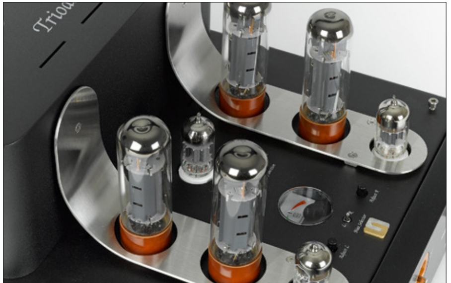
Die EL34-Röhren werden entweder als Pentode oder Triode genutzt. Umschalten können wir einfach mit einem kleinen Kippschalter
